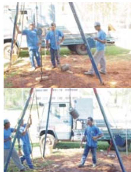
Demonstração prática da sondagem SPT.
